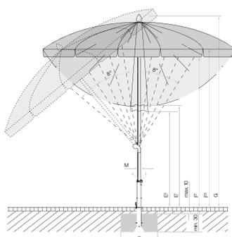
Rivestimento del soffitto sciolto max. 10 cm, spessore del cemento min. 30 cm (rispettare la profondità del gelo), Garantire lo scarico d'acqua
